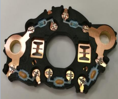
CONNETTORE PER ATTUATORE VALVOLA EGR - EXHAUST GAS RECIRCULATION (AUTOMOTIVE)
