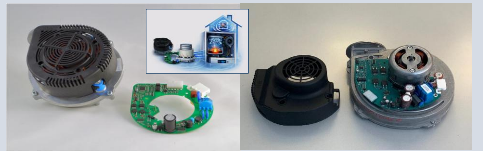
CENTRALINA ECU PER IL CONTROLLO DI MOTORI BRUSHLESS IN CALDAIE A CONDENSAZIONE (HOME APPLIANCES)
