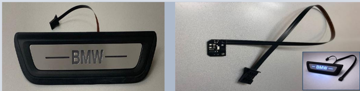
TECNOLOGIA DI SALDATURA HOT BAR PER IL COLLEGAMENTO FPCB-PCBA IN MODULI DI ILLUMINAZIONE (AUTOMOTIVE)
