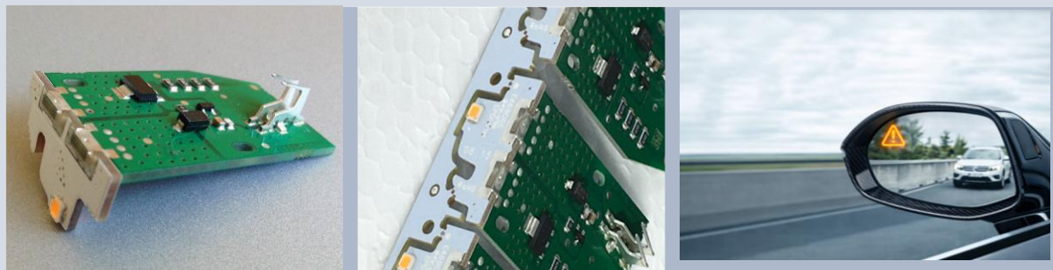
ELETTRONICA PER PICCOLI DISPOSITIVI DI ILLUMINAZIONE: FRECCHE, INDICATORI DI AVVISO LATERALI, LUCI DI CORTESIA, CATARIFRANGENTI (AUTOMOTIVE)
